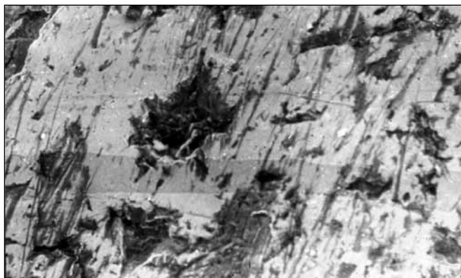
Рис. 6. Точечные дефекты на поверхности стального протеза при полировании пастой ГОИ
